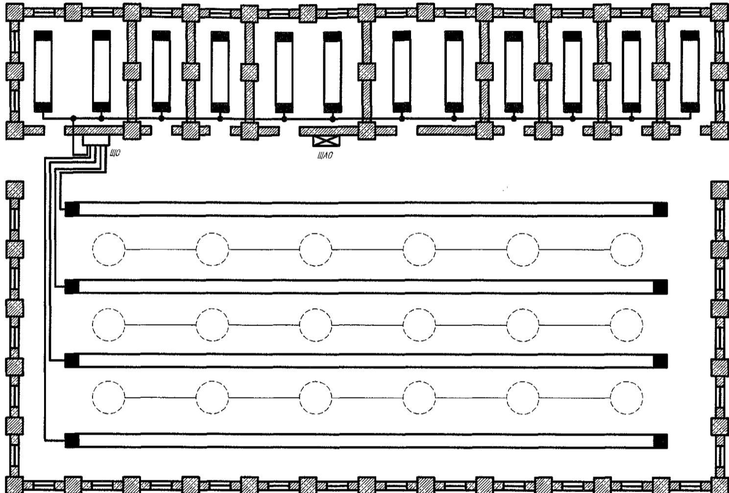
\*Общее освещение цеха выполнено светильниками типа АСП-13-2х65-003 с люминесцентными лампами ЛБ65-1
